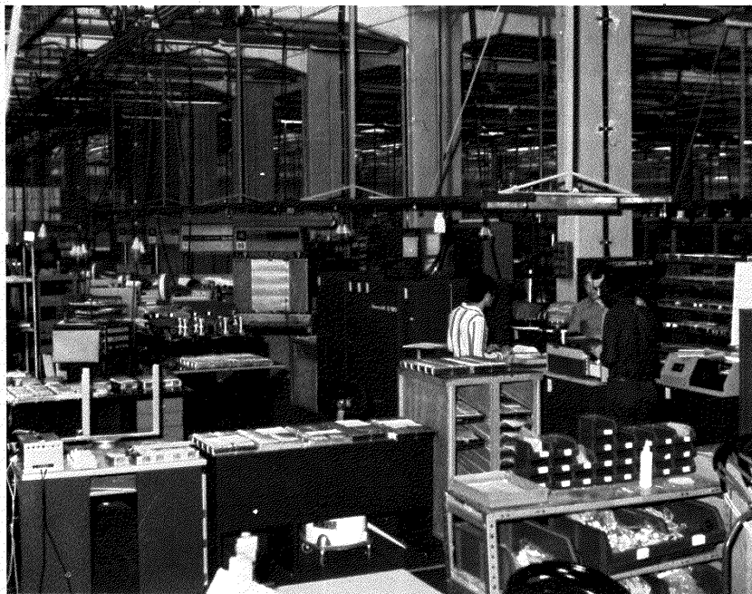
Collaudo cablaggi « wire-wrap » su apparecchiatura automatica pilotata da elaboratore.
