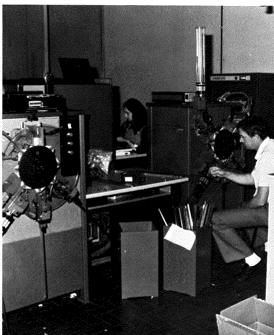
Controllo automatico di un pezzo lavorato alle macchine utensili, con misure di precisione su tre assi.
