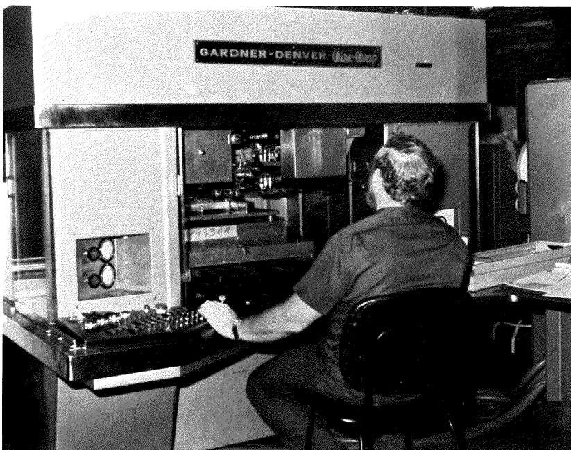
Cablaggi « wire-wrap » su macchina automatica orizzontale.
